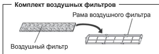
(2) Задействуйте защелку на обоих краях фильтра и два крючка в задней части рамы для воздушных фильтров.
